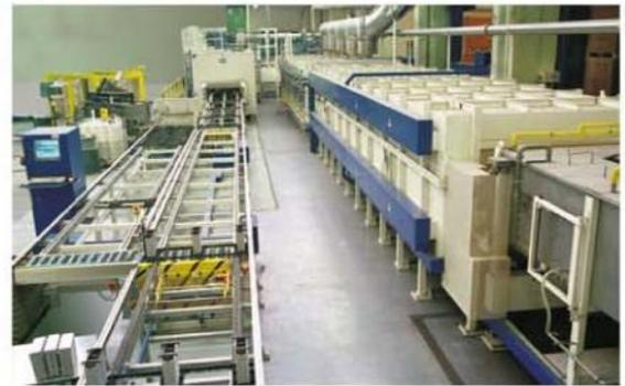
CAB - Lötlinie für Aluminium - Wärmetauscher (Pkw)
