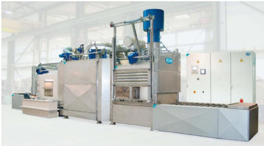
Lötanlage mit Abluftwäscher für die Produktion von großvolumigen Cu-/Ms-Wasserkühlern (z. B. für Nutzfahrzeuge)
