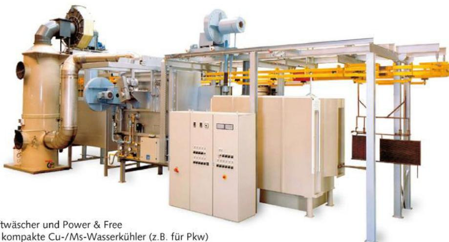
Lötlinie mit Abluftwäscher und Power & Free Fördersystem für kompakte Cu-/Ms-Wasserkühler (z. B. für Pkw)
