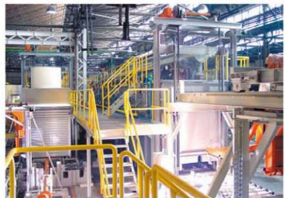
Aushärtelinie in Modulbauweise mit externer Fördertechnik; Prüf- / Signierstation für Zylinderköpfe
