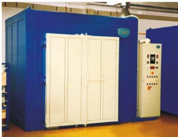
Warmauslagerungsanlage modularer Technik für Felgen
