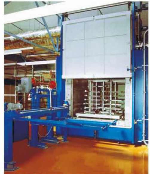
Lösungsglühlinie als Durchlaufanlage mit Wasserabschreckbecken und externer Fördertechnik für Felgen
