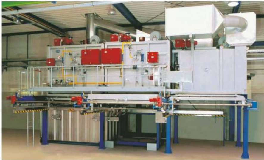
Aushärtelinie als Durchlaufsystem mit Haubenofen, Luft- und Wasserabschreckung für Kurbelgehäuse und Zylinderkopf
