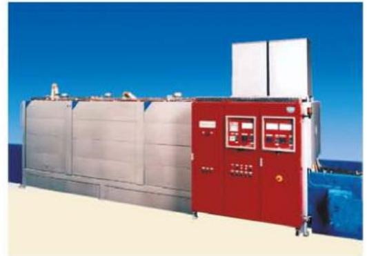
**Durchlaufofen** mit Luftkühlzone zum Anlassen von Antriebswellen
