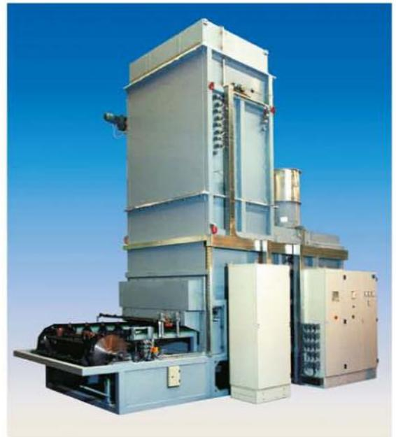
**Paternosterofen** mit Luftkühlzone zum Anlassen von Zahnstangen
