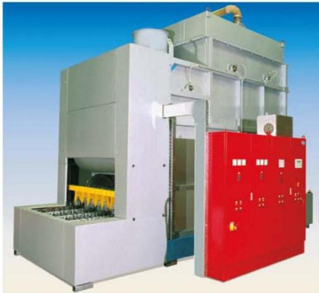
Paternosterofen mit Luftkühlzone zum Anlassen von Kurbelwellen
