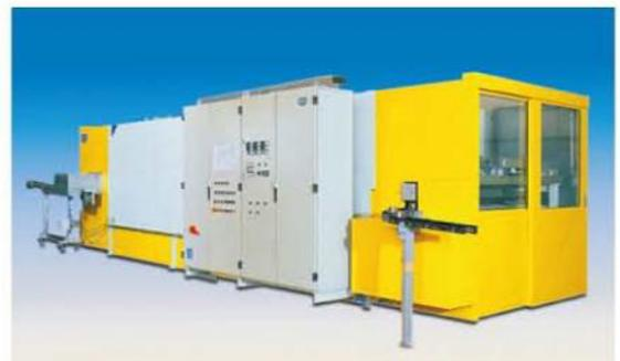
Durchlaufofen mit Luftkühlzone und kompletter Verkettung zur Wärmebehandlung von Antriebsteilen
