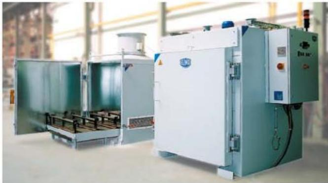
**Kammerofen** mit separater Luftkühlzone zum Anlassen von Getriebebauteilen
